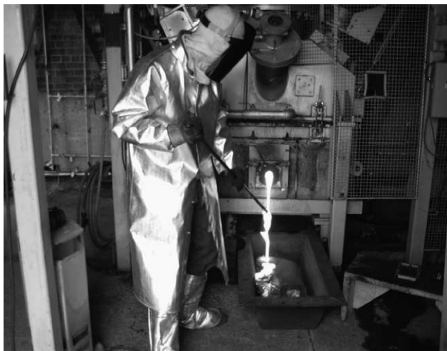
Fig. 5. Tapping inert slag.
